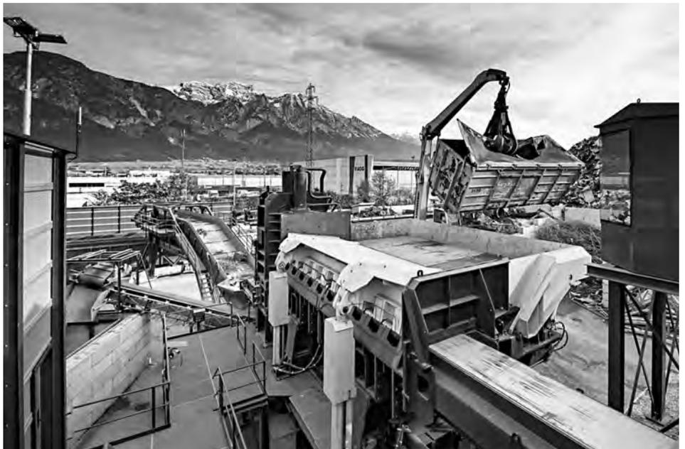
**Beeindruckend! Die Schrottschere zerlegt selbst große Container mit Leichtigkeit.**
